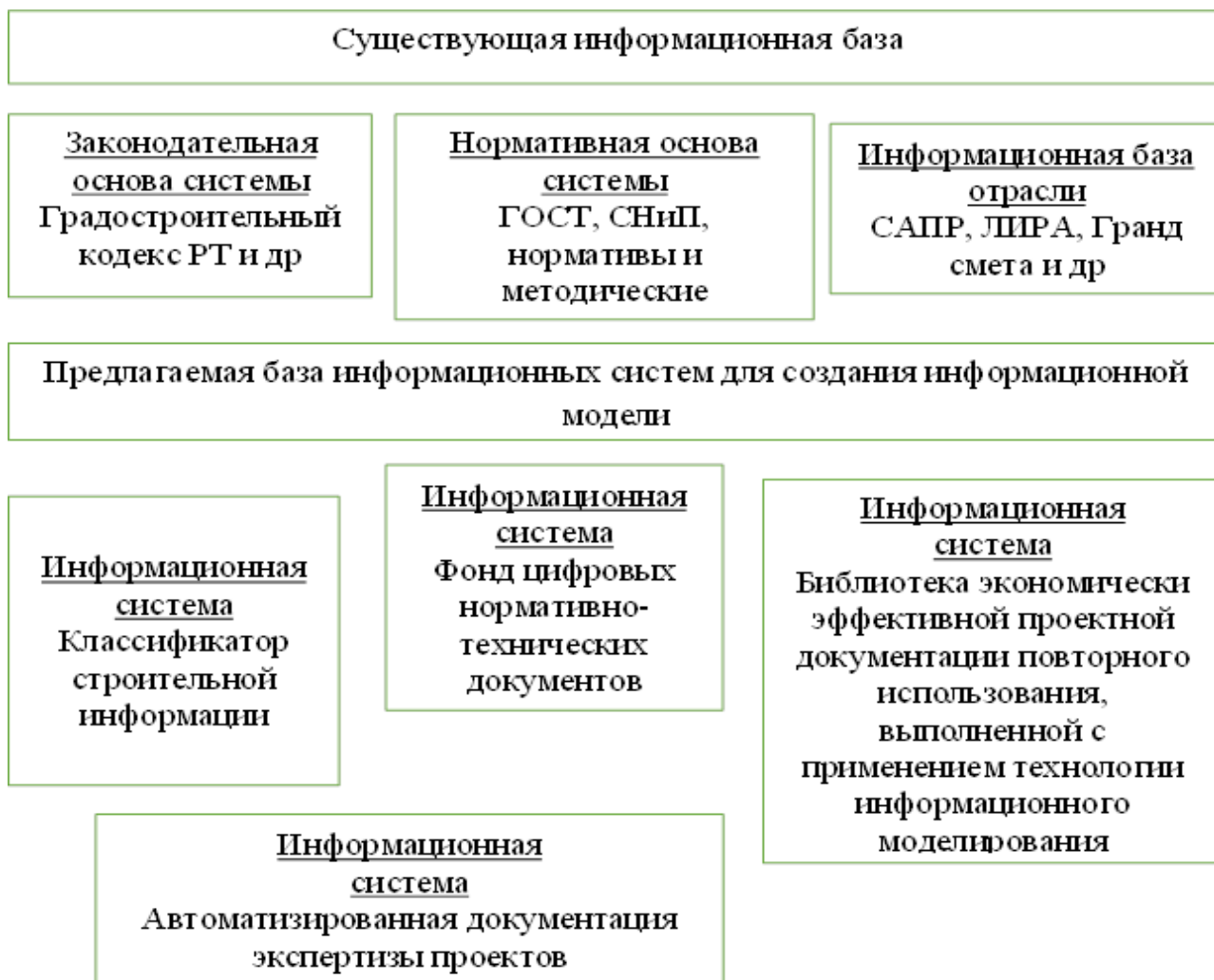
Рисунок 1. Структура сферы цифровой системы в строительстве.
