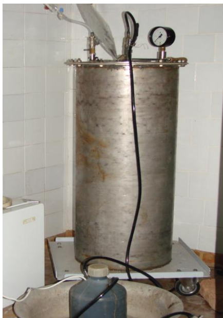
Рис.2. Биореактор (вид снаружи) для имитации водостока из полигона ТБО в анаэробных условиях.
